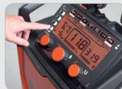
Модели Kempract Adaptive (A) предлагают специальные функции, в том числе возможность установки мощности в зависимости от толщины листа, выбор присадочного материала и каналы памяти.
