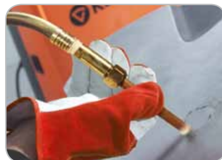
Функция HotSpot™ гарантирует простую и удобную тепловую усадку металла и нагрев деталей.
