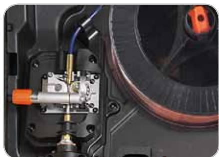
Модели Kemract 181/251 включают 2-х роликовый механизм подачи проволоки GT02C.
