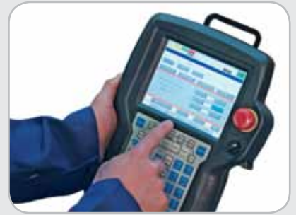
Подвесной пульт управления роботом отображает интерфейс KempArc Browser.
