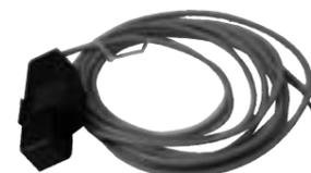
Индукционный датчик реагирует на изменение магнитного поля вокруг сварочного кабеля, по которому проходит постоянный или переменный ток свыше 25 А. Датчик крепится к кабелю с помощью специальной ленты ("липучки").
