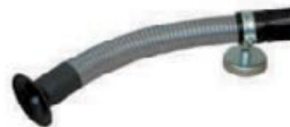
EN-20 это вытяжная насадка для соединения с вытяжным шлангом портативного высоковакуумного устройства PHV. Представляет собой гибкую трубу с воронкообразной насадкой на магнитной подставке. Насадку необходимо размещать на расстоянии 2-4 см от источника выделения вредных веществ.
