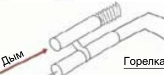
**Насадка НКТ** предназначена для установки на ствол стандартной сварочной горелки, удаляет дым над горелкой (максимальный диаметр – 24,5 мм.). Переходник с другой стороны шланга соединяется со шлангом или патрубком вытяжной установки ВВФр или аналогичных агрегатов.
